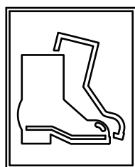
Utilice calzado de seguridad
