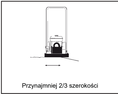
Położenie zagęszczarki podczas pracy na pochyłości.
