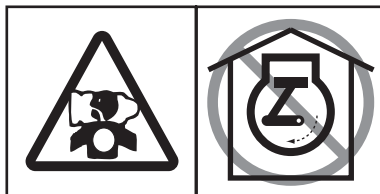
Il motore emette monossido di carbonio. Non accendere il motore in area molto chiuse
